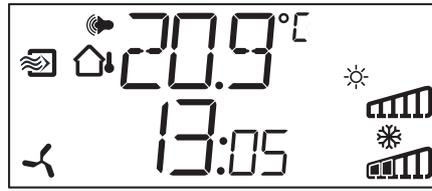
Vengono visualizzati il setpoint attuale e l'ora corrente. Sono presenti due barre grafiche che mostrano i livelli di uscita corrente unitamente a simboli che indicano la modalità di configurazione delle uscite (riscaldamento, raffreddamento, serranda, ecc.).
