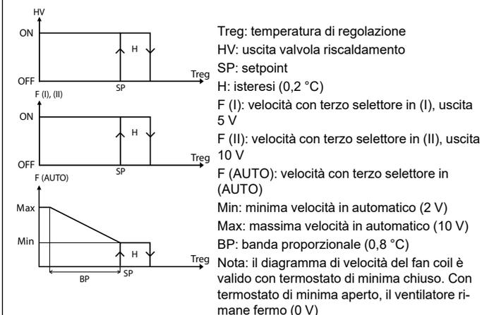
Quando la modalità "Ventilazione termostata" viene utilizzata in "Raffreddamento", la valvola (CV) e il ventilatore del fan coil, funzionano come indicato nel diagramma seguente.
