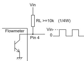
Nota: l'uscita in frequenza è un'onda quadra con un'oscillazione del 50% tra  $V_{in}$  (alimentazione positiva) e massa. La frequenza è disponibile sul pin 4 ed è necessario montare una resistenza esterna tra i pin 4 e 1 ( $R_L \geq 10 \text{ k}\Omega$  1/4 W).
