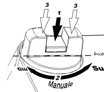
Per impostare manualmente la posizione della valvola, premere prima il centro della manopola finché non viene prodotto uno scatto e il pulsante rimane abbassato (1 in figura). Dopodiché è possibile modificare la posizione della valvola manualmente ruotando la manopola (2 in figura). Ruotando in senso orario, il perno si estende, mentre ruotando in senso antiorario esso si ritrae.
