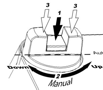
Pour régler manuellement la position de la vanne, appuyez sur la partie centrale du bouton jusqu'à entendre un clic. Elle doit rester enfoncée (n°1 sur le schéma ci-dessus). Il est alors possible de modifier manuellement la position du boisseau en tournant le bouton (n°2 sur le schéma ci-dessus). Tournez dans le sens des aiguilles d'une montre pour faire sortir la tige d'actionnement, ou dans le sens inverse pour la faire rentrer.
