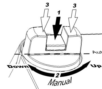
Die Ventilstellung kann manuell eingestellt werden, indem der mittlere Teil des Drehknopfes heruntergedrückt wird, bis er einrastet (1 in der Abbildung). Die Ventilstellung kann durch Drehen des Knopfes verstellt werden (2 in der Abbildung). Im Uhrzeigersinn wird die Antriebsstange nach unten, und gegen den Uhrzeigersinn nach oben bewegt.
