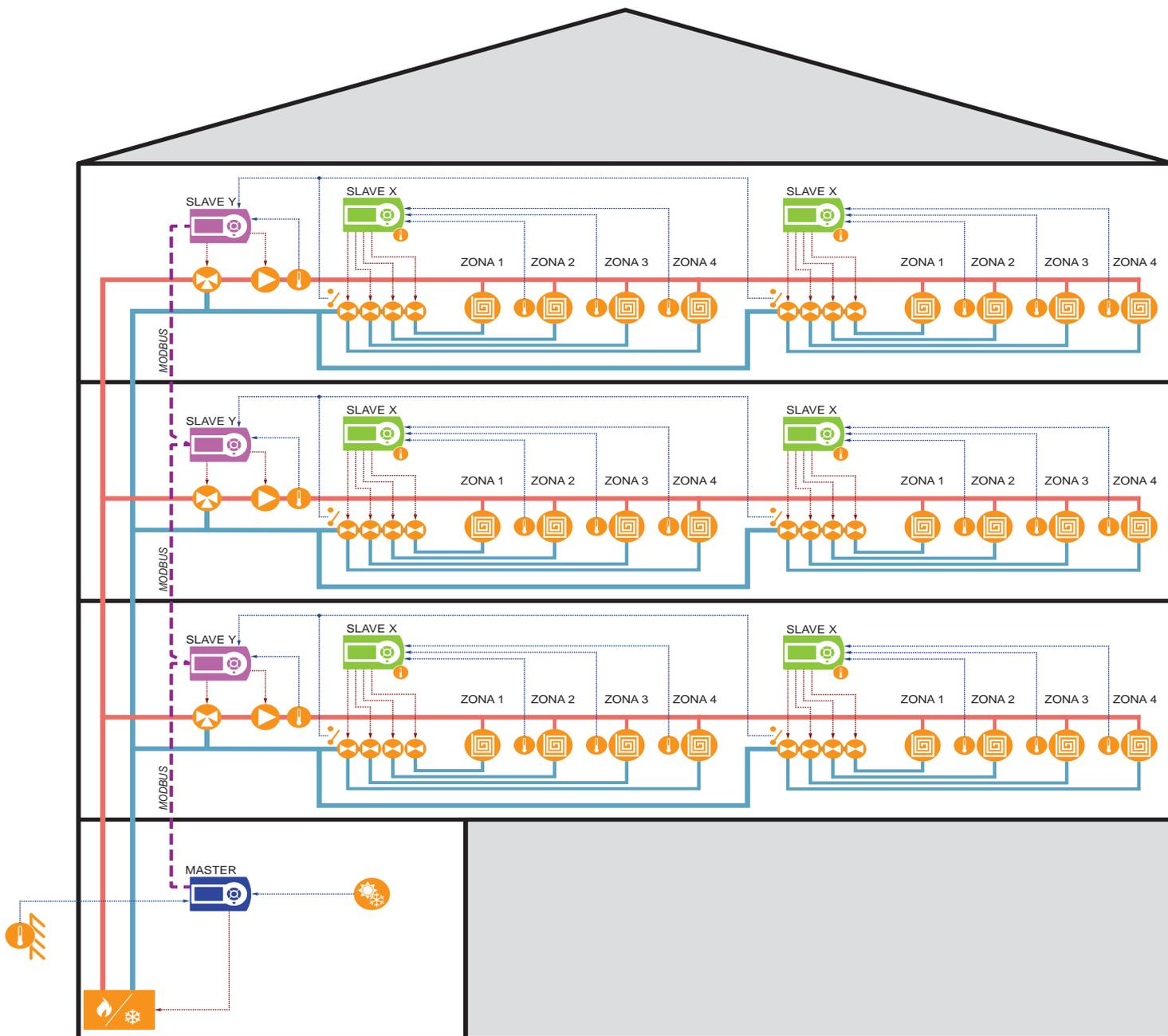
I regolatori SLAVE\_X trasmettono la richiesta regolazione al regolatore SLAVE\_Y tramite contatto. Il contatto di attivazione può essere sia quello della testina elettrotermica oppure quello del regolatore SLAVE\_X (solo per alcune configurazioni).
