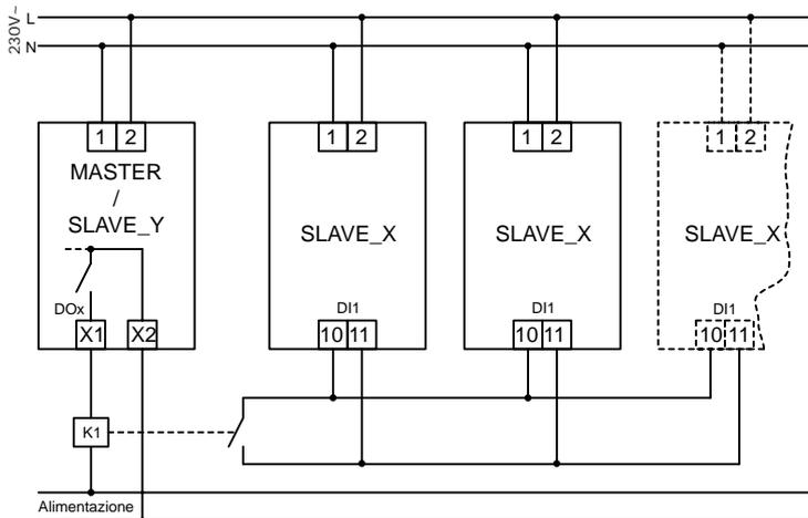
X1: uscita digitale per richiesta regolazione (morsetto modello FH-2 = 32, morsetto modello FH-4 = 34)
