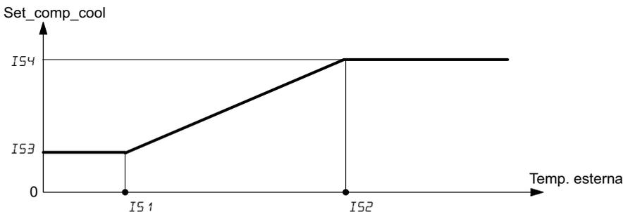
Nota: in caso di rottura della sonda esterna il setpoint di compensazione estivo viene comunque calcolato. Se la sonda esterna è aperta il setpoint di compensazione corrisponde a I53. Se la sonda esterna è in corto-circuito il setpoint di compensazione corrisponde a I54.
