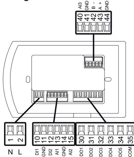
\* Nel caso di utilizzo di trasmettitori di umidità con uscita 0...10V, seguire i collegamenti come indicato nella figura 2. Negli altri casi (sonda di temperatura) effettuare i collegamenti come in figura 1.
