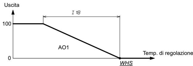
WHS setpoint di compensazione calcolato in base alla curva di compensazione invernale vedere paragrafo "17. Regolazione con compensazione setpoint" pagina 56.
