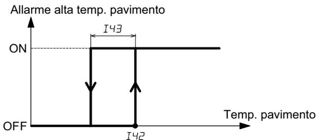
Se viene oltrepassata la massima temperatura del pavimento (I 42) per la zona considerata, compare il messaggio "FL-H" nella pagina degli allarmi e lampeggiano le icone e per il raffreddamento o le icone e per il riscaldamento.
