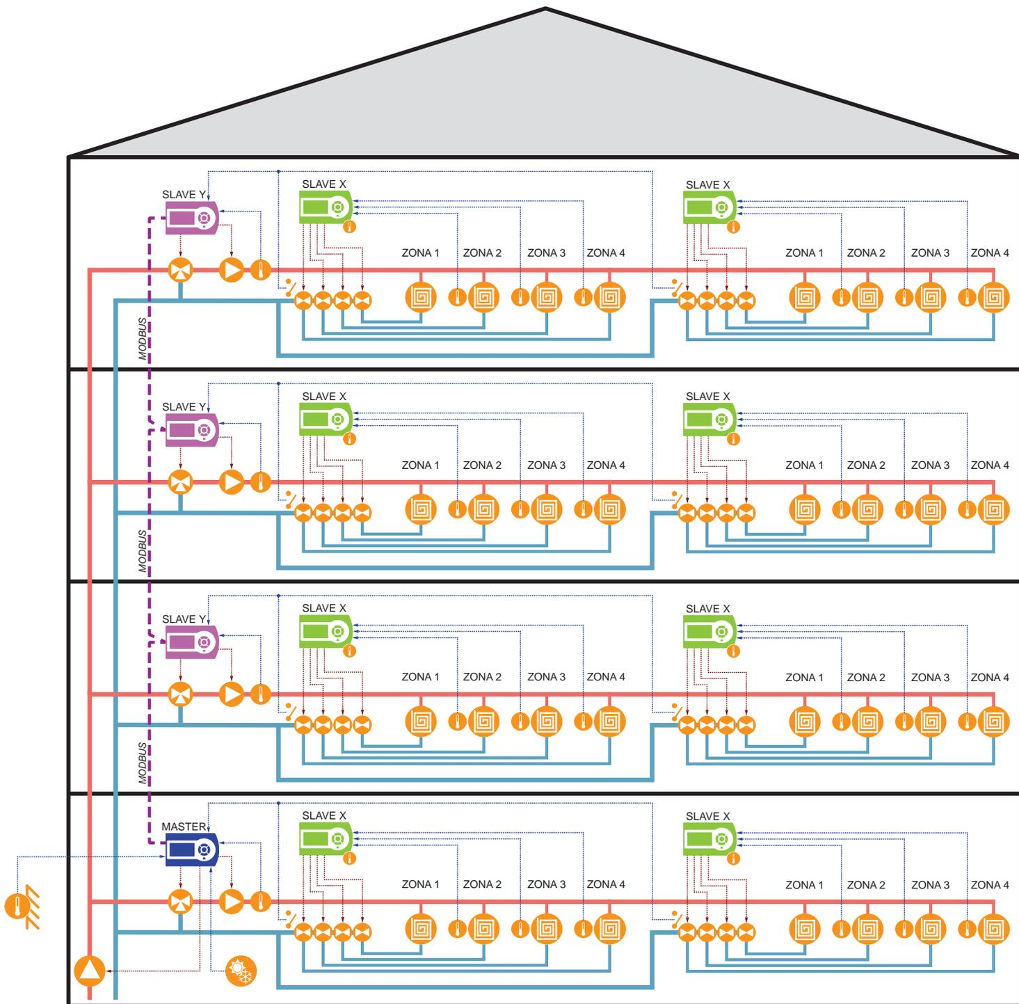
Alcuni regolatori SLAVE\_X trasmettono la richiesta regolazione al regolatore SLAVE\_Y tramite contatto, altri al regolatore MASTER. Il contatto di attivazione può essere sia quello della testina elettrotermica oppure quello del regolatore SLAVE\_X (solo per alcune configurazioni).
