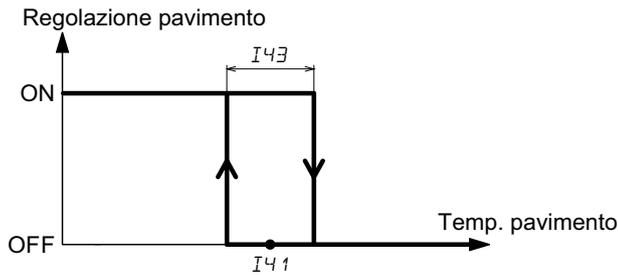
Fare attenzione a non impostare la temperatura minima del pavimento ad una temperatura troppo alta, altrimenti un surriscaldamento dell'ambiente è possibile.
