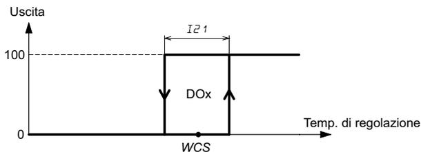
WCS setpoint di compensazione calcolato in base alla curva di compensazione vedere paragrafo "17. Regolazione con compensazione setpoint" pagina 56.
