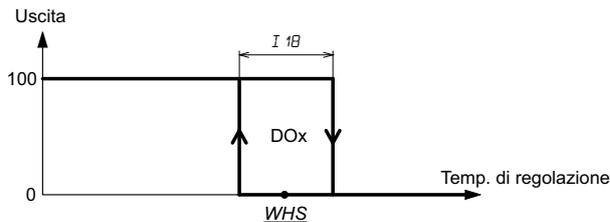
WHS setpoint di compensazione calcolato in base alla curva di compensazione vedere paragrafo "17. Regolazione con compensazione setpoint" pagina 56.
