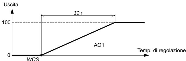
WCS setpoint di compensazione calcolato in base alla curva di compensazione vedere paragrafo "17. Regolazione con compensazione setpoint" pagina 56.
