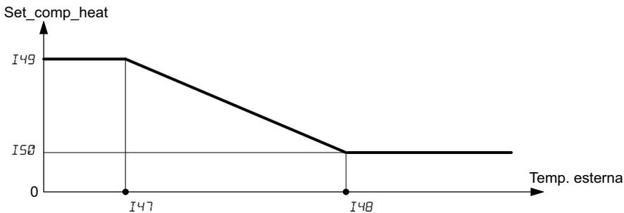
Nota: in caso di rottura della sonda esterna il setpoint di compensazione invernale viene comunque calcolato. Se la sonda esterna è aperta il setpoint di compensazione corrisponde a I49. Se la sonda esterna è in corto-circuito il setpoint di compensazione corrisponde a I50.
