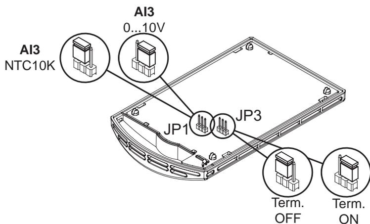
**JP3=Term. ON** → resistenza 120 ohm di terminazione linea Modbus INSERITA (modello **FH-xMxSH1**).
