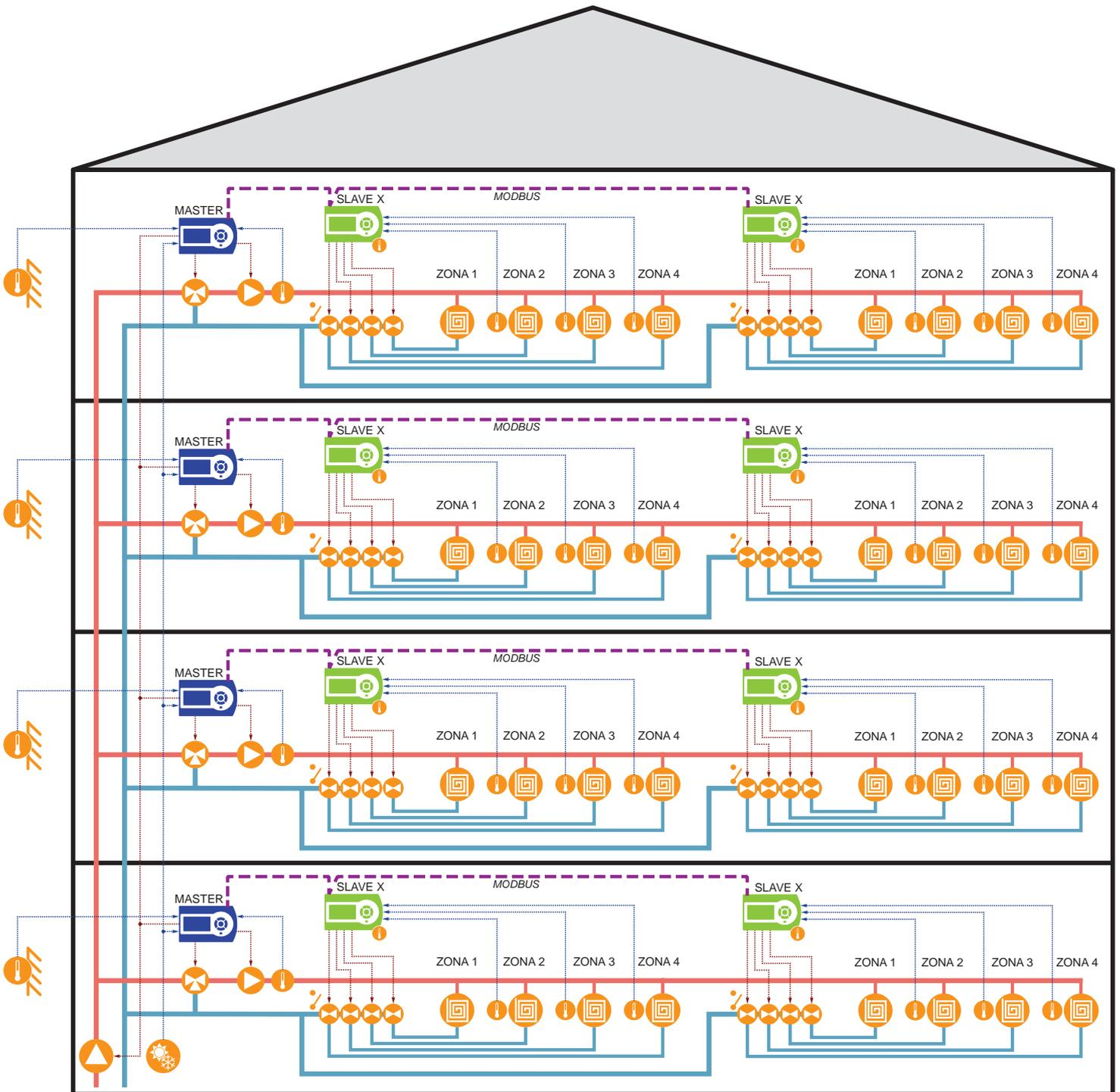
Ogni regolatore MASTER è indipendente dagli altri regolatori MASTER, ed è collegato via Modbus a dei regolatori SLAVE\_X. La pompa colonna è comandata da tutti i regolatori MASTER. Ogni regolatore MASTER avrà una sonda esterna se necessario.
